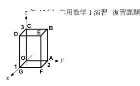
この立方体の 6 面(面 DEFG, 面 ABCO, 面 ABEF, 面 OGDC, 面 BCDE, 面 AFGO)を面積分によって計算する。 面 DEFG は $\bar{\bf n}=\bar{\bf i}$ , x=1であるので、
